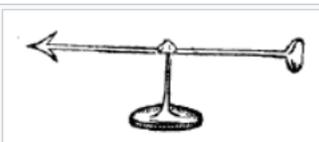
Le « Versorium » de Gilbert, l'électroscope déterminant la présence de charges électriques.
